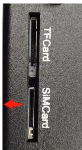
如左图所示 SIM 在插入时要保证卡片有缺口的那边向内，有芯片的一面向左，插入到底时会听到“咔”的一声表示安装到位，取卡时也是向内再按一次即可自动弹出。
