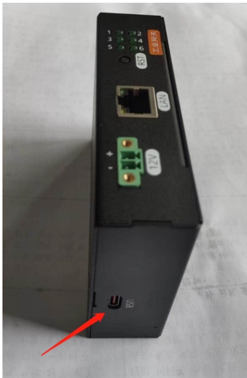
USB 为标准 Type-C 接口，可以使用 Type-C 数据线将网关连接到电脑的 USB 口或者 USB 电源适配器。该接口可用于供电及与电脑进行数据通讯。
