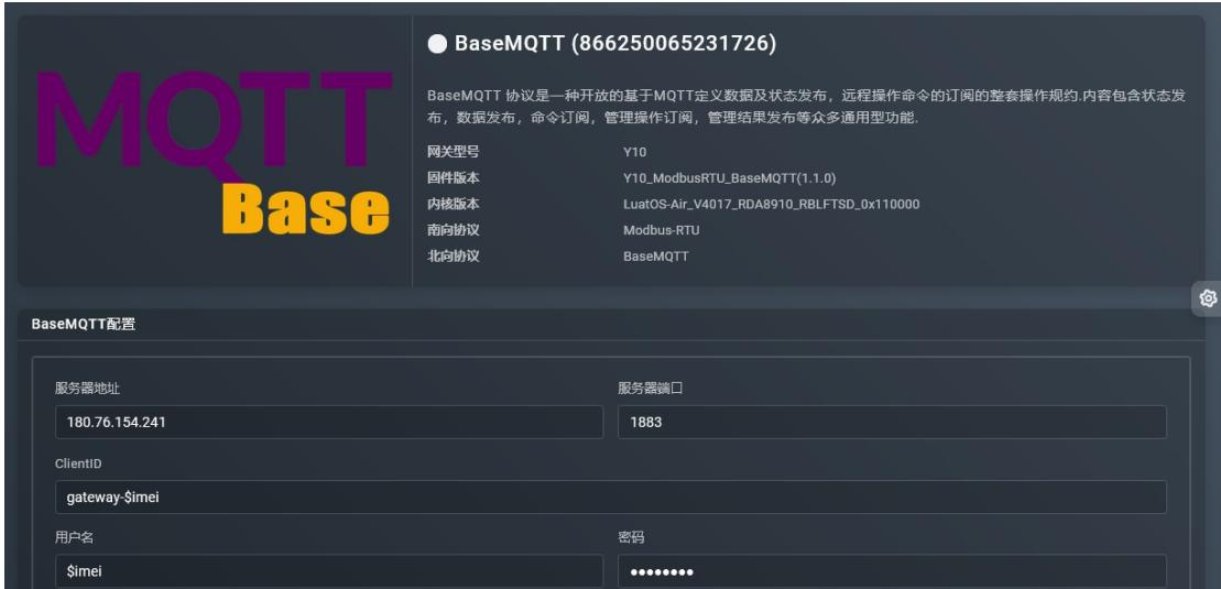
180.76.154.241 是我用来测试的 MQTT 服务器，配置完成之后点下载就可以，网关会自动重启生效。
